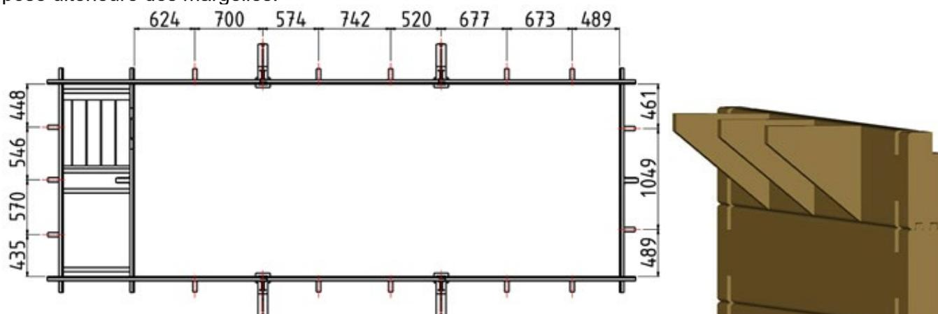
Figure 16 – Emplacements des consoles de margelles
