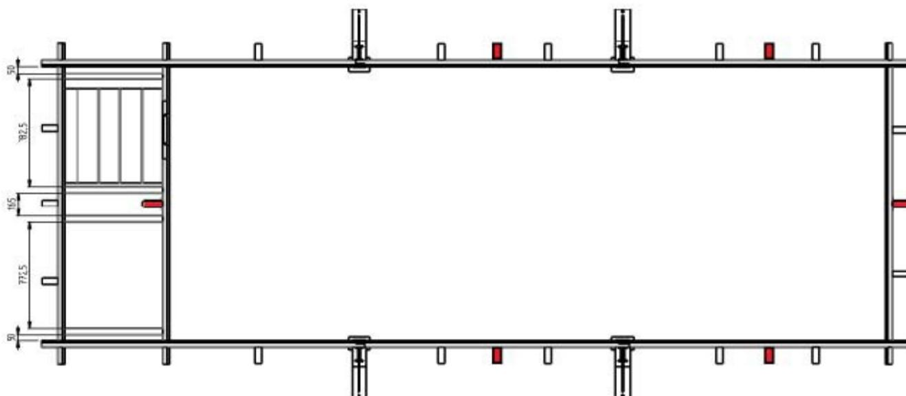
Figure 13 – Montage des plaques métalliques sur les consoles de margelles
