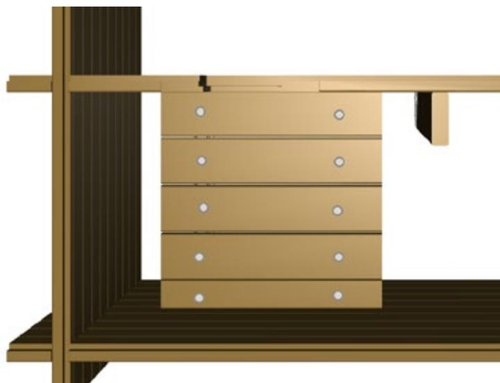
Figure 15 – Assemblage du fond de coffre
