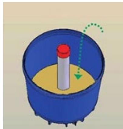
Verser doucement 20 kg de sable dans le filtre et l'étaler à la main..
