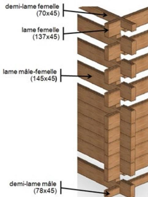
Figure 8 – Principe d'emboîtement des lames de bois
