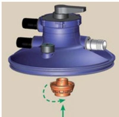
Centrer le diffuseur dans le logement, et le plaquer contre le couvercle, lui appliquer une rotation pour que la languette du diffuseur s'engage dans la rainure en U du couvercle, cela jusqu'à la butée.
