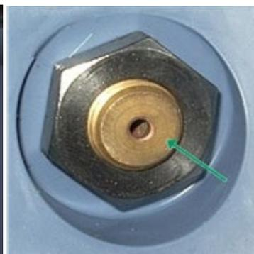
Par le dessous du couvercle, vissez l'écrou laiton à la main puis serrez modérément à la clé à pipe de 22 afin de ne pas détériorer le joint.
