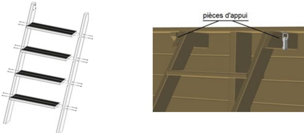
Figure 37 – Montage de l'escalier extérieur en bois
