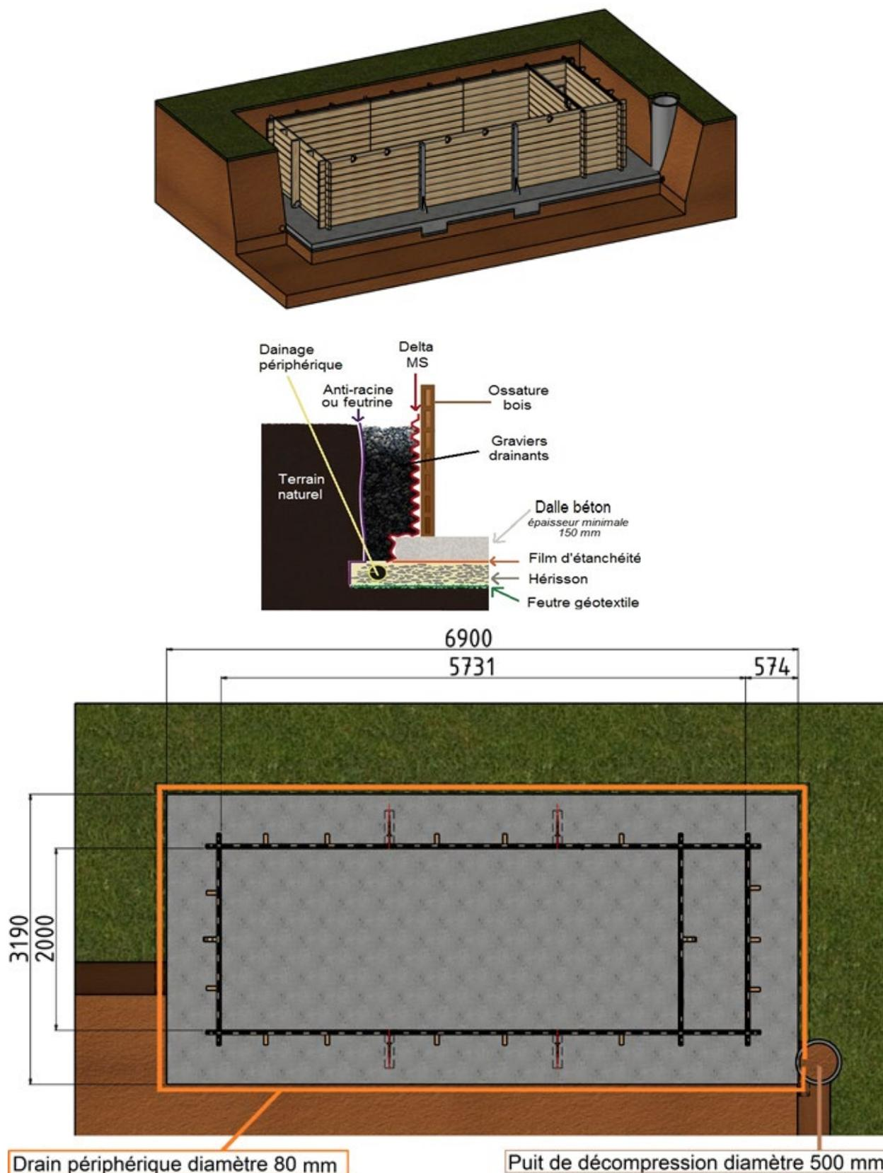
Figure 1 – Plan de pose du système de drainage
