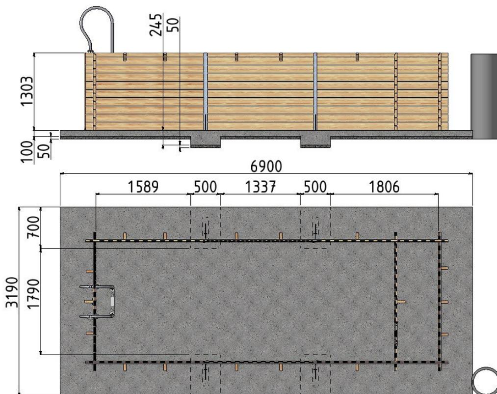
Figure 5 – Caractéristiques de la dalle de béton
