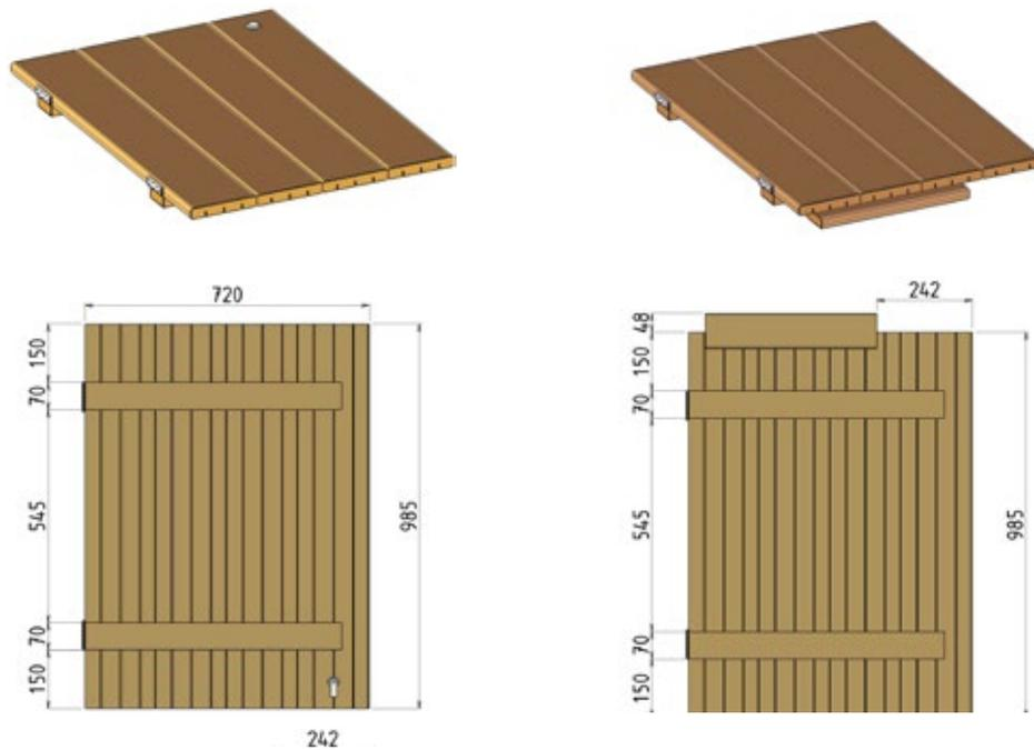
Assemblez le caillebotis avec verrou en utilisant 4 margelles de 985 × 180 × 28 mm, dont celle percée pour le passage du verrou, et 2 tasseaux de 650 × 70 × 28 mm.
