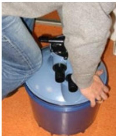
Présenter le couvercle au dessus de la cuve. Enfoncer le couvercle dans la cuve en un point. Conserver l'appui sur ce point à l'aide du genou.
