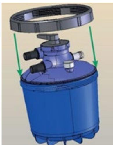
Pousser simultanément sur les deux mains pour emboîter complètement le couvercle. Conserver la pression sur le couvercle et mettez en place la ceinture de serrage, puis serrez énergiquement à la main seulement.
