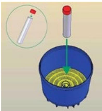
Vérifier que le plancher filtrant est bien en place au fond de la cuve. Insérer le tube collecteur coiffé de son bouchon de protection dans le trou au milieu du plancher filtrant.
