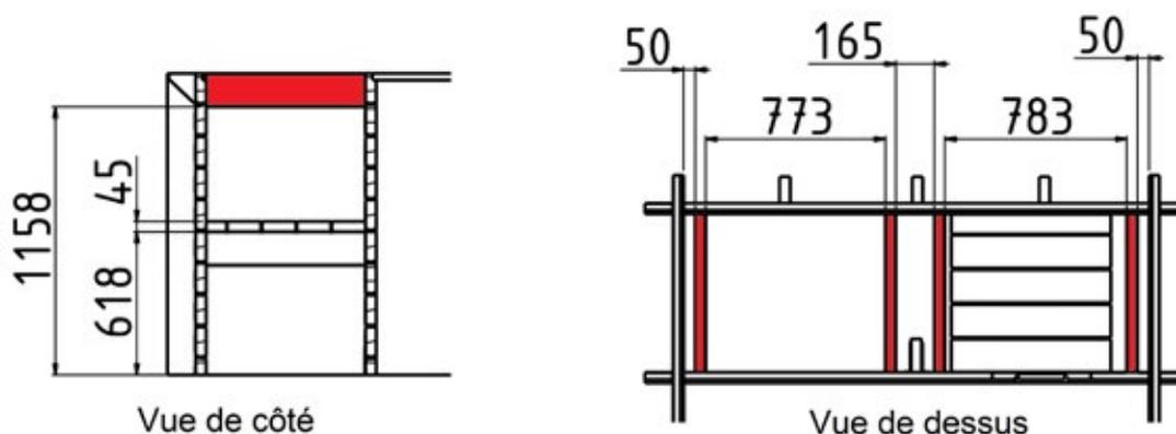
Figure 17 – Emplacements des renforts de coffre
