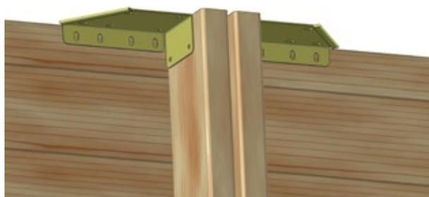
Figure 18 – Mise en place des équerres de margelles en haut des jambes de force
