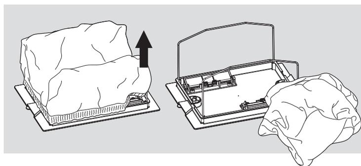
Nettoyez le sac de filtrage à l'aide d'un tuyau d'eau.
