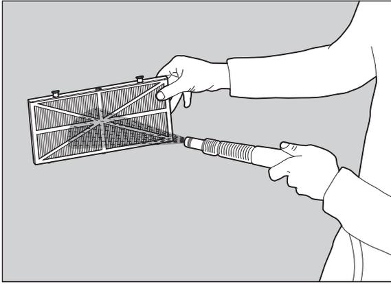
Nettoyez les filtres à l'aide d'un tuyau d'eau.
