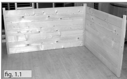
1. Au début mettez la paroi droite et arrière (pièce I) ensemble, comme vous le voyez en fig.1.1. Les vis doivent être visibles à l'extérieur. Vissez les deux éléments. (vis 5x80). Faites le même avec la paroi gauche. La paroi arrière est monté entre les deux cotés extérieurs.
