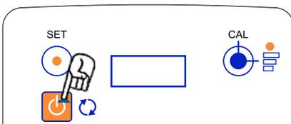
Lorsque l'appareil est éteint, « OFF » est affiché. Un appui bref sur la touche « ON/OFF » allume l'appareil.
