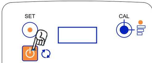
Lorsque l'appareil est éteint (afficheur OFF), maintenir appuyée la touche ON/OFF pendant au moins 3 secondes pour débiter l'amorçage.
