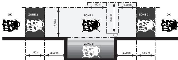
Установите насос в проветриваемом сухом месте. Необходимо обеспечить возможность свободного движения воздуха вокруг электродвигателя для создания условий естественной вентиляции.
