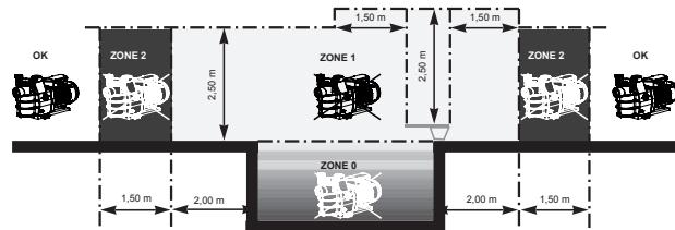
Instale a bomba num local arejado e seco: o motor exige que o ar circule livremente à volta da bomba de modo a obter-se uma ventilação natural.
