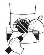
3. Utilisez un tournevis large, desserrez le cadran de commande. Soulevez soigneusement le cadran jusqu'à ce qu'il sorte.
