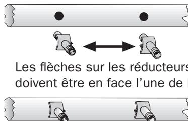
Les flèches sur les réducteurs doivent être en face l'une de l'autre.
