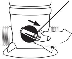
1. Repérez la goupille de fermeture, à l'arrière du Perform-Max. Baissez le centre de la goupille de verrouillage avec le doigt, et otez-la du cadran.
