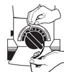
7. Utilisez un petit tournevis ou un instrument pointu afin d'aider la bague à rentrer, assurez-vous que la bague reste à sa place une fois insérée.
