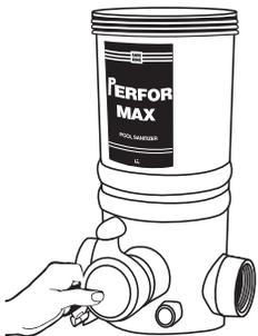
4. Réinsérez soigneusement le cadran de commande dans le logement.
