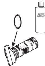
4. Remplacez soigneusement le joint torique en caoutchouc sans le tendre. Appliquez le silicone sur le joint torique.
